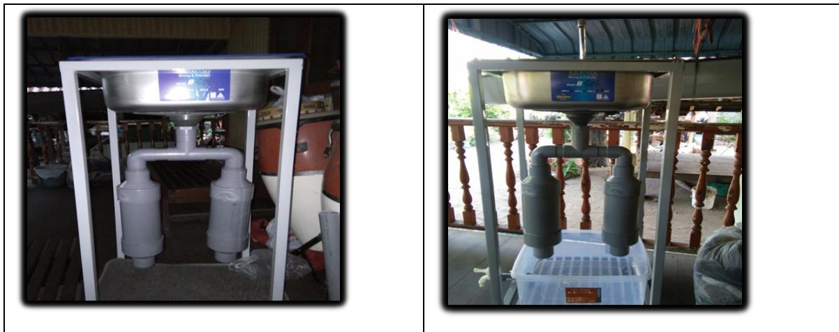
Rajah 4.5: Penapis air yang terdiri dari lapisan batu bata, pasir, kain putih dan arang.
