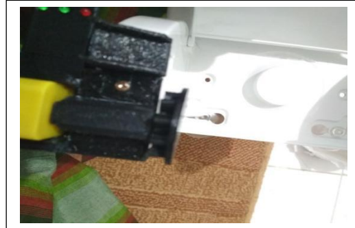
Rajah 8 : Memasang gear , tapak sensor dan motor DC pada tisu gulung
